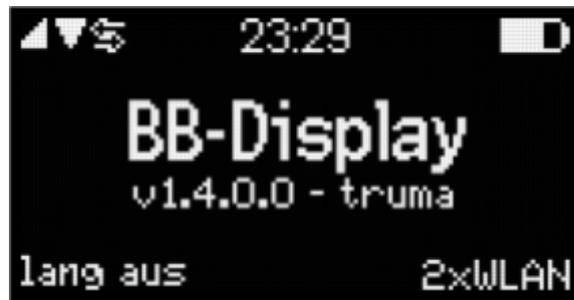
Wird der **TIN-Adapter** über **USB-C** mit dem **BB-Display** verbunden und die Stromversorgung eingeschaltet, erkennt das BB-Display den Adapter **automatisch beim nächsten Neustart**. In der **Startanzeige** erscheint dann die Firmware-Version mit dem Zusatz „-truma“. Die Firmware des BB-Display **ab Version 1.4.0.0** unterstützt den **TIN-Adapter**.
