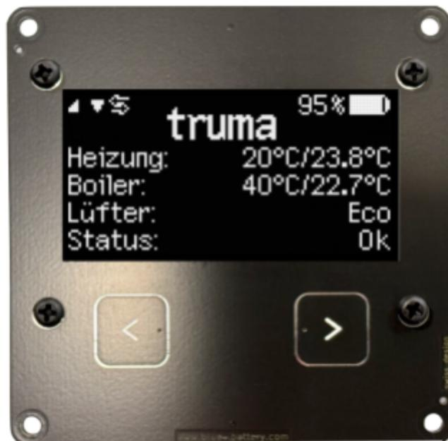
Wird das BB-Display in ein **WLAN-Netzwerk** eingebunden und ein **MQTT-Server** eingerichtet, lässt sich die Heizung bequem über eine Smartphone-App wie z. B. **IoT MQTT Panel** fernsteuern.
